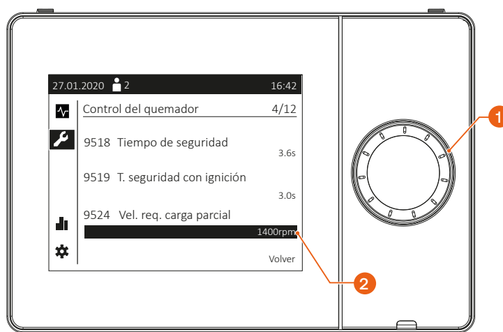
Fig. 28. Ajuste de velocidad del ventilador: pantalla típica
